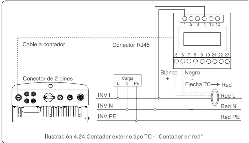
Ilustración 4.24 Contador externo tipo TC - "Contador en red"
