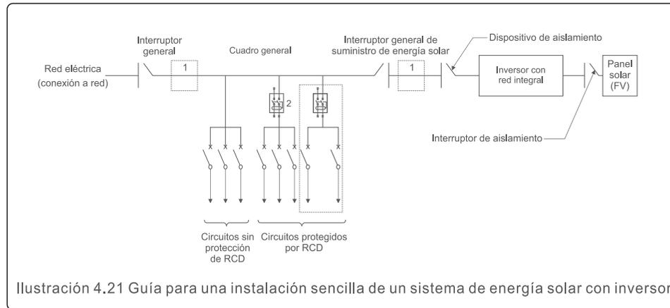
1. El RCD debe ir en conexión paralela entre las redes de consumidores y el suministro solar.
