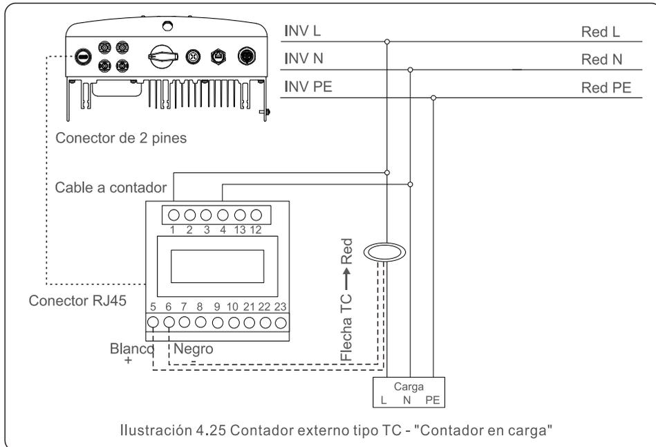
Ilustración 4.25 Contador externo tipo TC - "Contador en carga"
