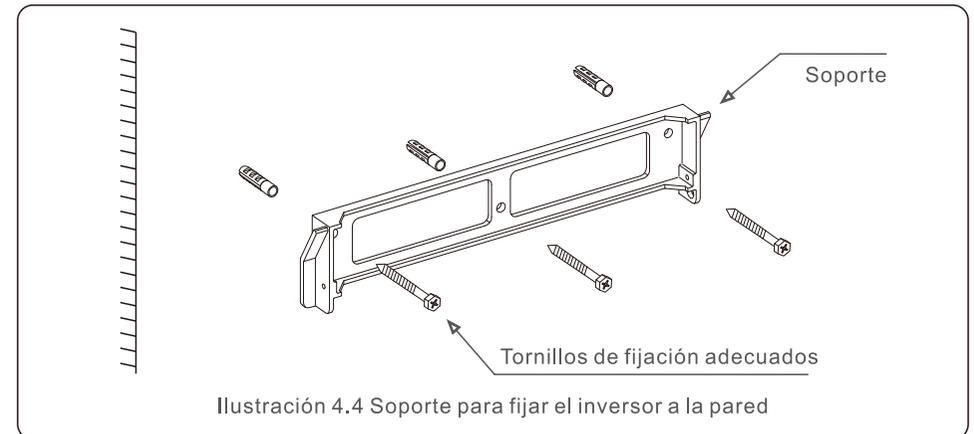
2. Asegurarse de que el soporte está en posición horizontal y de que los orificios de sujeción (Ilustración 4.4) se marcan correctamente. Taladrar los orificios en la pared en su marca correspondiente.
