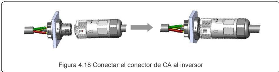
Figura 4.18 Conectar el conector de CA al inversor
