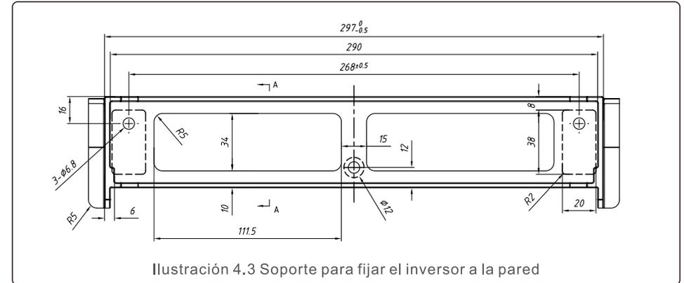
Ver ilustraciones y 4.5 para conocer las instrucciones de montaje del inversor. El inversor debe montarse verticalmente. Los pasos para montar el inversor se enumeran a continuación.
