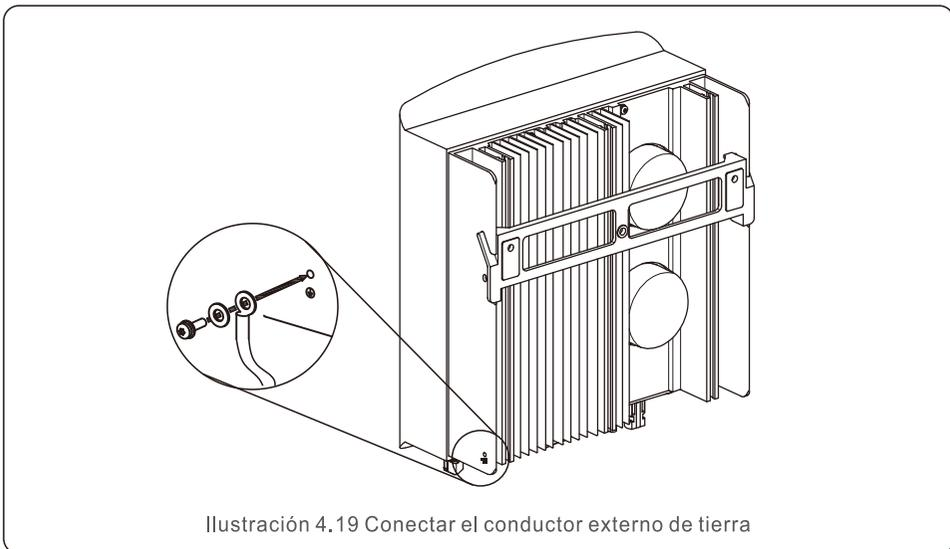
Ilustración 4.19 Conectar el conductor externo de tierra
