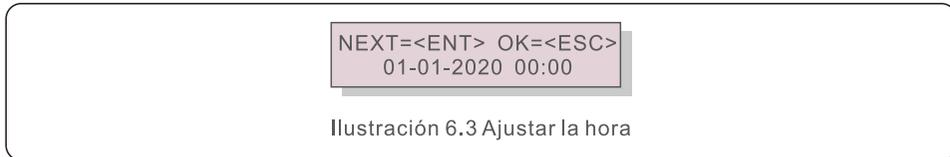
Pulsar 'UP/DOWN' (ARRIBA/ABAJO) para ajustar la hora y los datos. Pulsar 'ENTER' para pasar de un dígito al siguiente (de izquierda a derecha). Pulsar 'ESC' para guardar los ajustes y volver al menú anterior.
