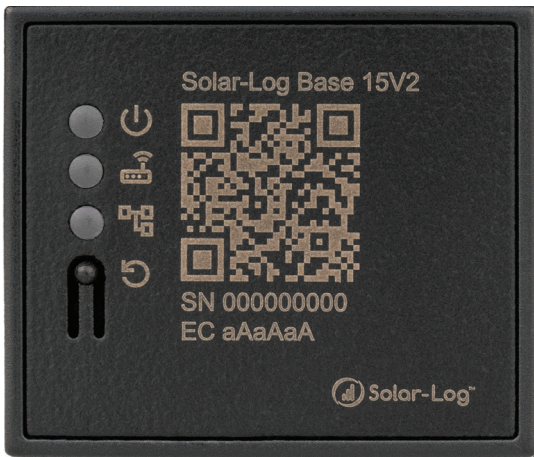
Fig.: Vista frontal del Solar-Log™ Base 15V2 con LEDs y tecla de reset
