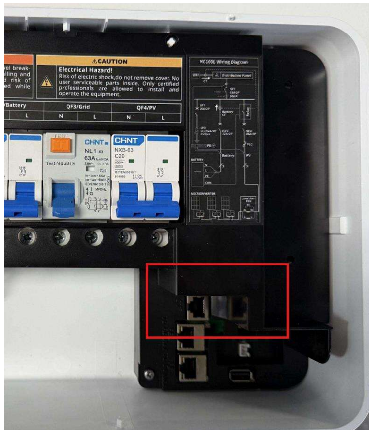
Imagen 14. Conector RJ45 hembra para conexión de toroidal de consumo
