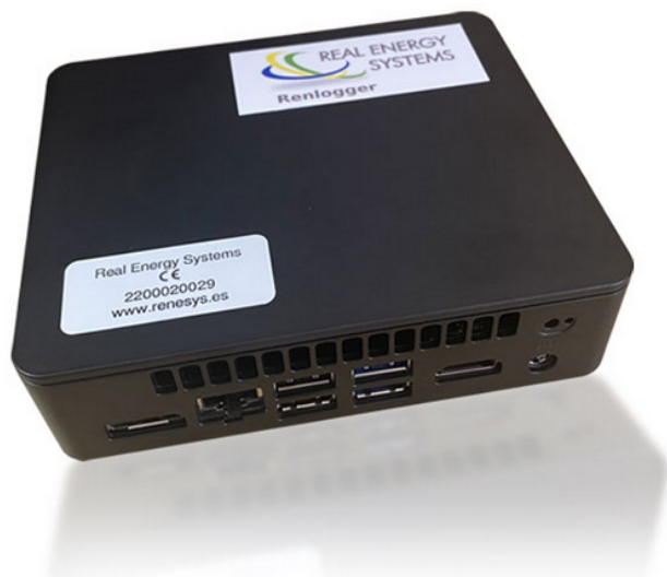
Figura 1 RENLOGGER – El equipo de la gama PRISMA para la gestión de comunicaciones y aplicaciones especiales
