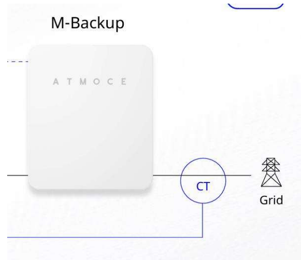
Imagen 13. Lugar de conexión de toroidales aguas arriba de instalación fotovoltaica y consumo
