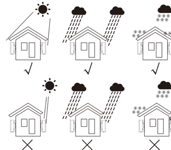
Figura 5.1 Ubicaciones de instalación recomendadas
